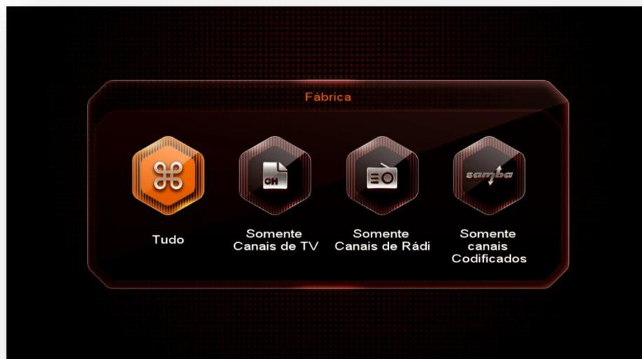
**OBS:** aconselha-se a fazer reset de fábrica (opção TUDO) após cada atualização para que todas as configurações do usuário sejam retiradas do sistema e o seu decodificador volte à condição de configuração de fábrica. Caberá nova configuração de acordo com suas preferências e necessidades.
