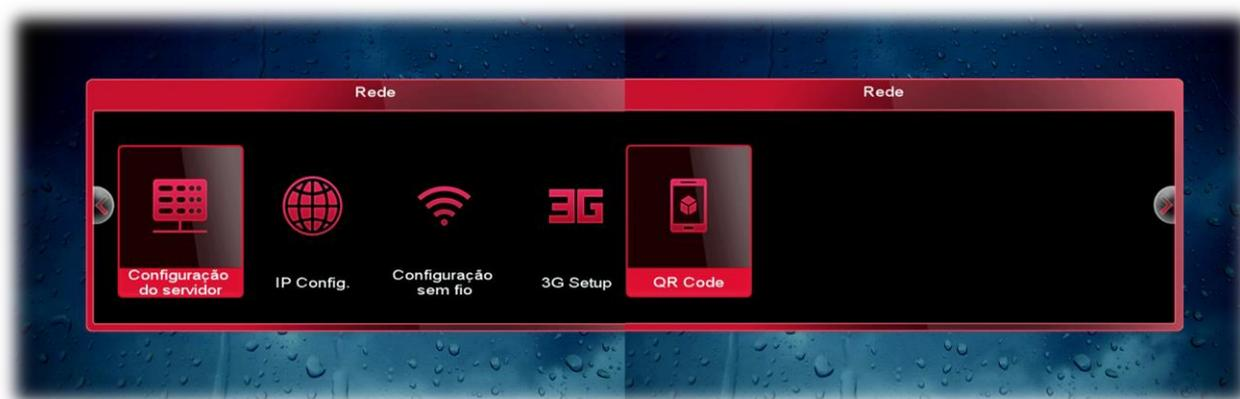
**5.1.1) Menu Rede>>Config. Network>>Configuração do Servidor:** sub menu onde serão realizados os ajustes e configurações para o uso do servidor 40 que é exclusivo para IKS nativo (AzAmerica/America Box) ou de servidor eleito pelo usuário. Atente que o servidor nº 40 não deve ser utilizado para outro fim que não seja o IKS nativo. Caso não o queira ativado, use a tecla Verde do controle remoto para essa tarefa. Demais
