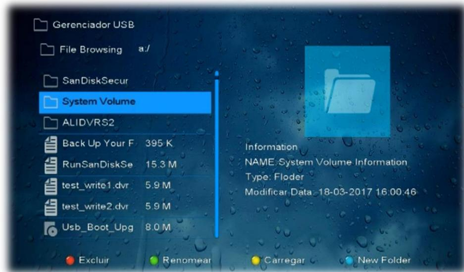
Nesse menu, **utilizando-se a tecla amarela do controle remoto**, poderá ser realizado um **backup em HDD ou pendrive** das configurações do seu decodificador.
