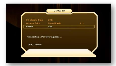
Habilite o 3G via opção Enable, alterando para YES>>pressione [OK] no controle remoto>>aguarde conexão com a operadora.
