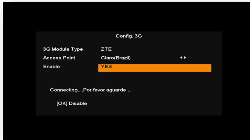
Habilite o 3G via opção Enable, alterando para YES>>pressione [OK] no controle remoto>>aguarde conexão com a operadora.
