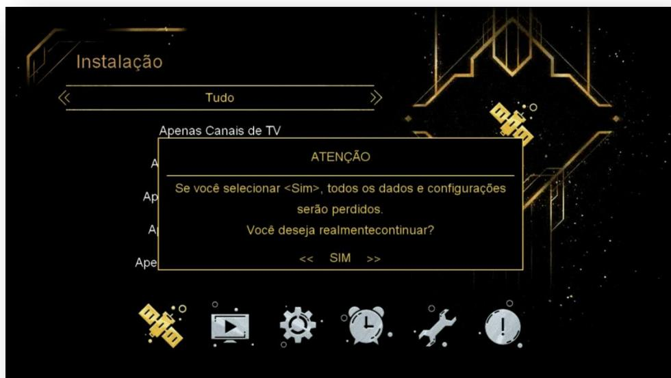
**OBS:** aconselha-se a fazer reset de fábrica (opção TUDO) após cada atualização para que todas as configurações do usuário sejam retiradas do sistema e o seu decodificador volte à condição de configuração de fabrica. Caberá nova configuração de acordo com suas preferências e necessidades.
