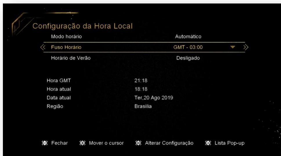
No modo automático bastará conectar antena dos canais para que o horário seja corrigido automaticamente.
