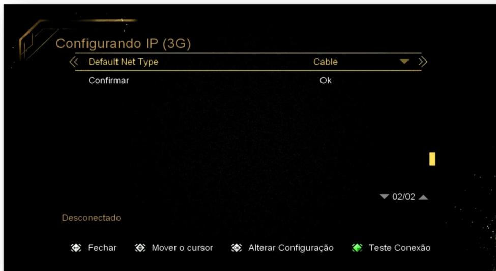
**OBS:** Mensagens “*Sem interface de rede*” tem origem em erros cometidos quando da seleção de modos de internet sem alteração da opção Default Net Type (Cable, wifi ou 3G).
