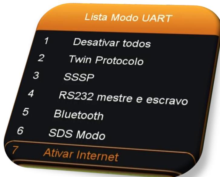
Esse comando ativará a opção do **servidor 40** no **Menu>>Expansão>>Servidor**, responsável pela comunicação do seu decodificador com o servidor da Az-America.
